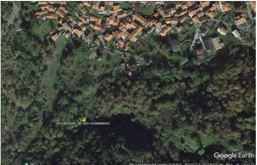
*Posizionamento GPS del sinkhole di Sassalbo. (MS). Altitudine (bordo inferiore ovest): 780 m slm; Diametro medio: 40 m. Profondità (livello acqua del fondo dal bordo): minima (ovest) 6 m, massima (est) 15 m.*
