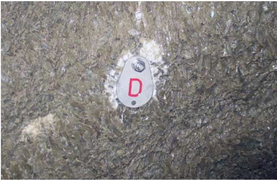
Fig. 2 - Placchetta in acciaio fissata con fix che contraddistingue i 26 capisaldi principali (foto arch. CVSC).
